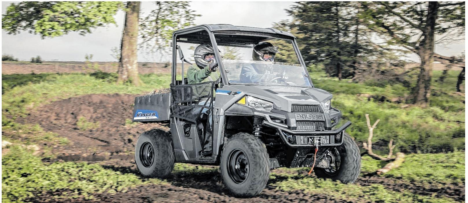
**Klassenführende Reichweite.** Mit dem auf maximale Leistung ausgelegten 11,7-kWh-Batteriesatz, den 3 Fahrmodi sowie der Reichweite von bis zu 80 km bietet der Polaris Ranger EV die beste Gesamtleistung seiner Fahrzeugklasse.
