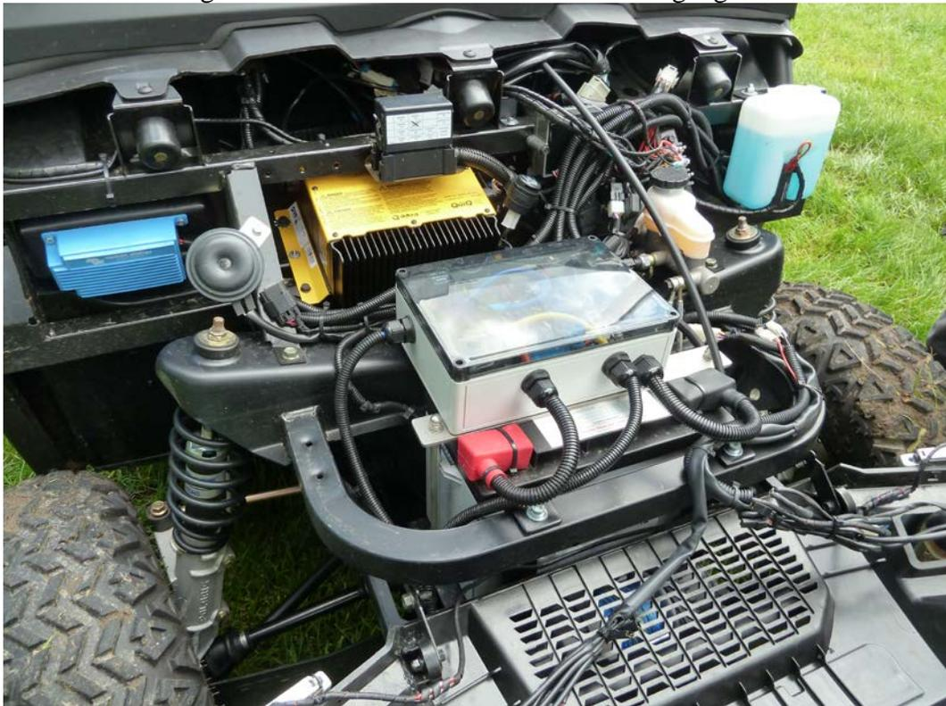
Stromversorgungsbox, Zusatzbatterie und Ladegerät
