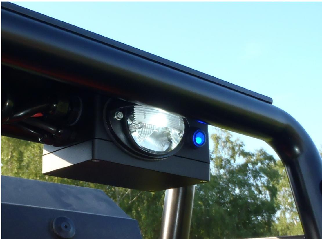
LED-Ladeflächenleuchte an Strombox montiert
