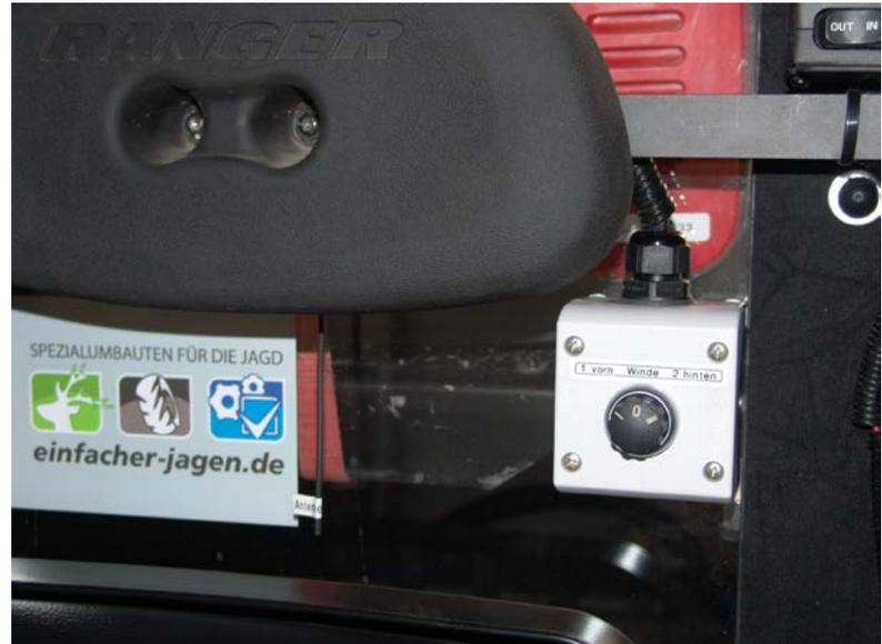
Wahlschalter und Antenne unterhalb der Kopfstütze
