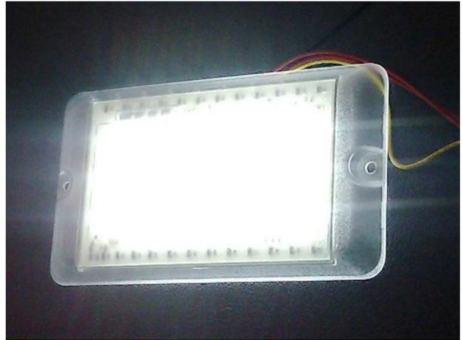
Diese wasserdichte (IP 65) LED-Leuchte wird mit einem abgewinkelten Aufbaurahmen (weiß oder schwarz) am Kabinendach montiert. Sie besitzt eine integrierte Steuerelektronik für 10,5-15,5 Volt. Das Leuchtpaneel hat ein sehr helles weißes Licht ohne Blauanteil, bei einem sparsamen Verbrauch von 2-8 Watt. Geschaltet wird sie über einen mehrstufigen Schalter im Armaturenbrett.
