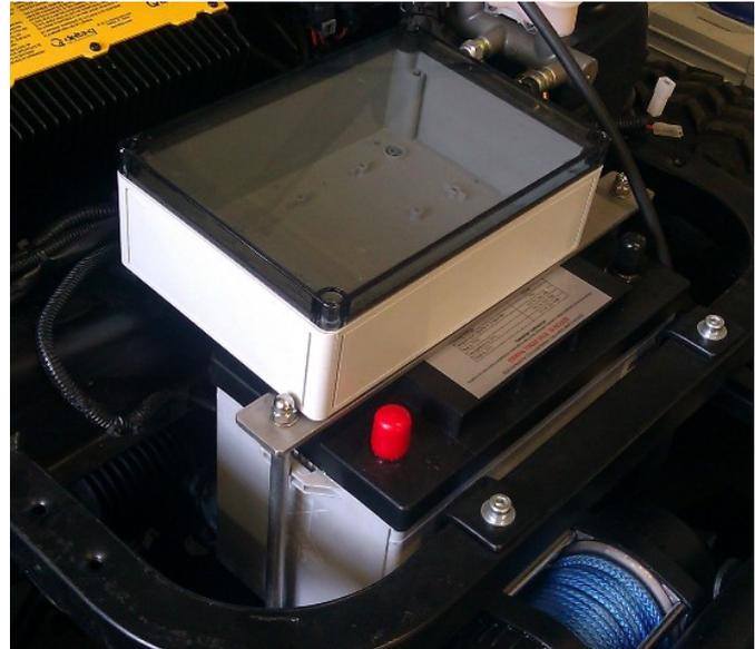
Stromverteilerbox über Zusatzbatterie
