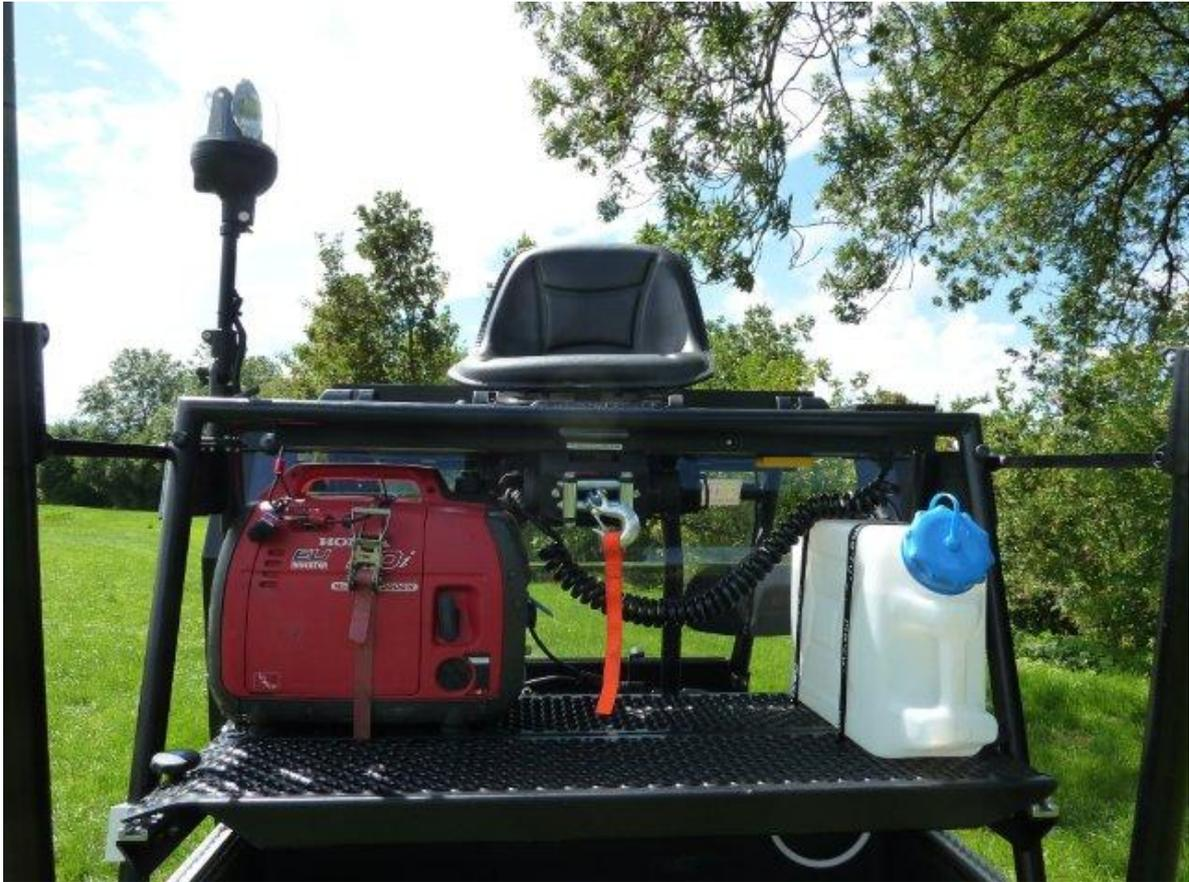
Foto zeigt den Generator auf der zweiten Ladeebene mit Multifunktionsbügel und Zubehör
