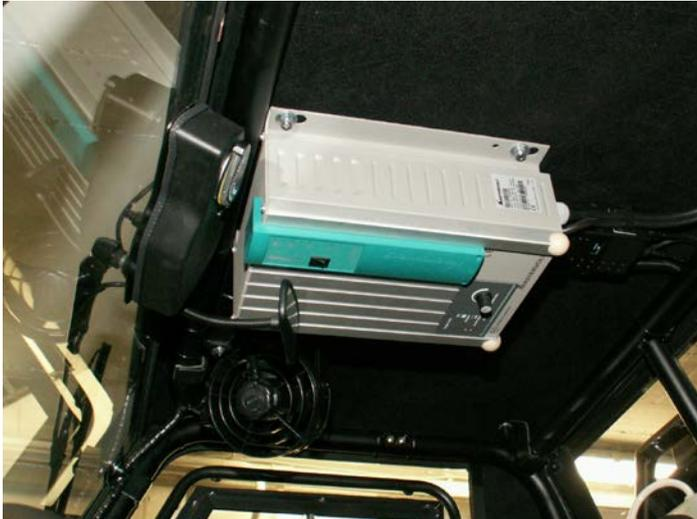
Hochleistungsladegerät am Kabinendach montiert
