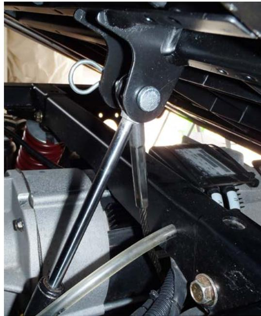
Wird die Ladefläche mit Zuladung oder Aufbauten gekippt, besteht die Gefahr, dass der Dämpfer beim Anschlag auseinander reißt.
