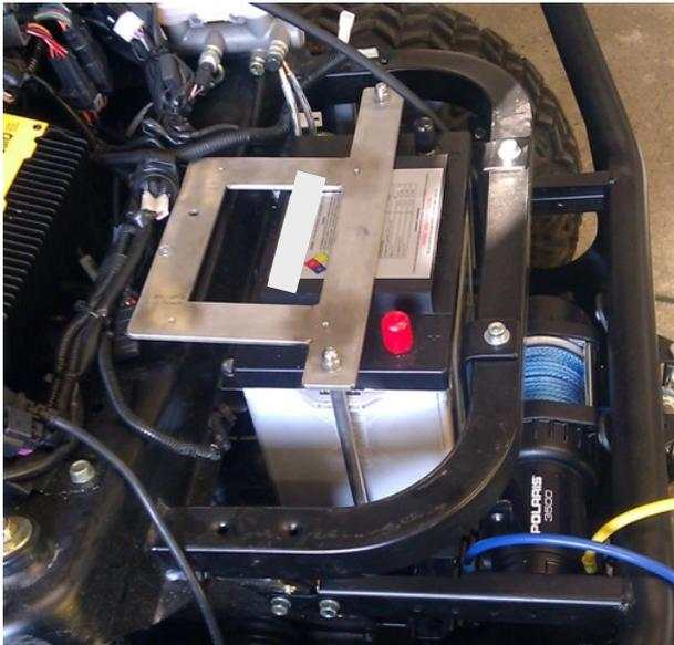
Batteriehalter über Winde
