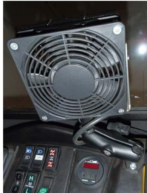
Effektive Heizung für den Elektro-Ranger mit geringem Stromverbrauch. Ein Heizmodul in Verbindung mit einem starken Lüfter sorgt für freie Sicht, auch bei zugefrorener Scheibe. Über einen Schalter kann entweder nur der Lüfter oder zusätzlich die Heizung bedient werden. Durch die flexible Halterung lässt sich die Windrichtung genau einstellen.
