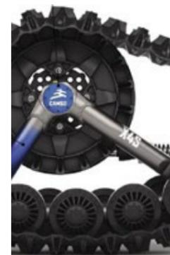
◆ Doppelt gelagerte Naben und Ölbadgehäuse für optimale Haltbarkeit der UTV4S und X4S
